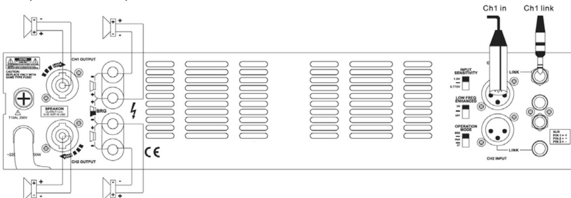
In deze modus wordt alleen ingang CH1 gebruikt. Sluit de audio bron (CD speler, mengpaneel, audio processor enz.) op deze ingang aan. Set de modus schakelaar op PARALLEL. Stel beide volume regelaars gescheiden in en gebruik beide TURNLOCK uitgangen (of de twee terminals).
