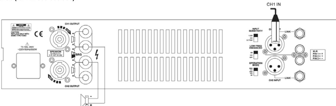
In dieser Betriebsart wird nur der Eingang CH1 benutzt. Schließen Sie die Audioquelle (CD Spieler, Mischpult, Audioprozessor...) an diesen Eingang an. Stellen Sie den Betriebsartwahlschalter auf BRIDGE. Stellen Sie den Lautstärkeregler von CH1 ein und benutzen Sie die beiden Ausgangsklemmen im Brückenbetrieb (+Klemme der Box an +Klemme von CH1 und -Klemme der Box an +Klemme von CH2)
