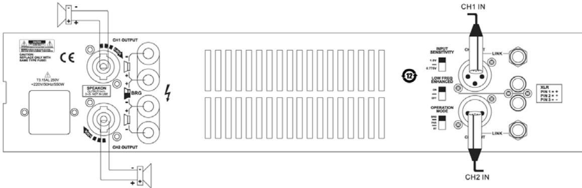
Dans ce mode, les deux entrées sont reliées aux sorties de la source audio ( lecteur CD, table de mixage, processeur audio,... ). Positionnez le sélecteur de mode de fonctionnement sur la position stéréo ( réglage usine ). Ajustez correctement les deux boutons volume séparément et utilisez les deux sorties TURNLOCK ( ou les deux sorties borniers ).
