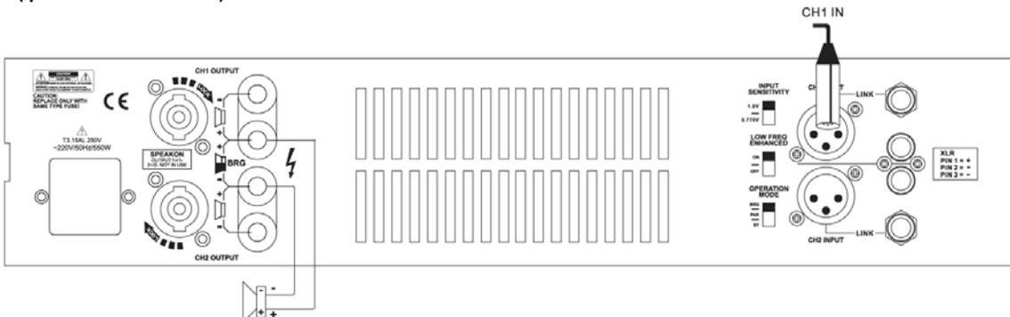
Dans ce mode, uniquement l'entrée CH1 est utilisée. Connectez la source audio ( lecteur CD, table de mixage, processeur audio,... ) sur cette entrée. Positionnez le sélecteur de mode de fonctionnement sur la position bridge. Ajustez correctement le boutons volume CH1 et utilisez les deux sorties borniers en mode bridge ( borne + enceinte sur borne + CH1 et borne – enceinte sur borne + CH2 )
