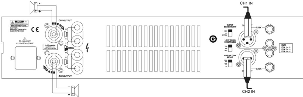
In dieser Betriebsart sind beide Eingänge an die Ausgänge der Audioquelle (CD Spieler, Mischpult, Audioprozessor...) angeschlossen. Stellen Sie den Betriebsartwahlschalter auf STEREO (Werkseinstellung). Stellen Sie beide Lautstärkeregler separat ein und benutzen Sie die beiden TURNLOCK Ausgänge (oder die beiden Klemmen).
