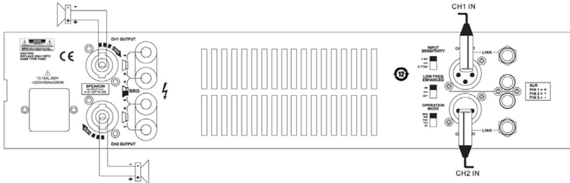
In deze modus zijn beide ingangen op de uitgangen van de audio bron (CD speler, mengpaneel, audio processor enz.) aangesloten. Zet de modus schakelaar op STEREO (default instelling). Stel beide volume regelaars gescheiden in en gebruik de TURNLOCK uitgangen (of de twee terminals).
