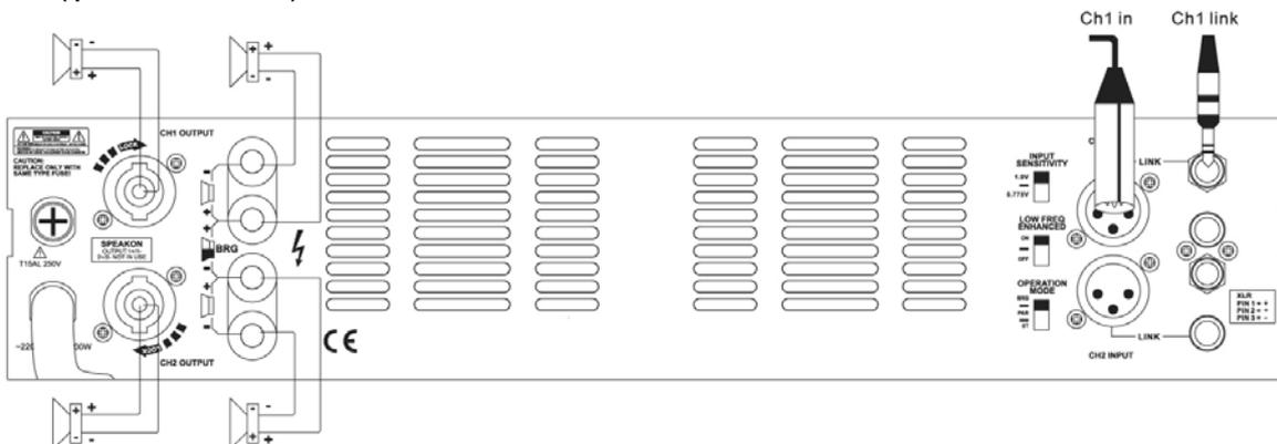
Dans ce mode, uniquement l'entrée CH1 est utilisée. Connectez la source audio ( lecteur CD, table de mixage, processeur audio,... ) sur cette entrée. Positionnez le sélecteur de mode de fonctionnement sur la position parallèle. Ajustez correctement les deux boutons volume séparément et utilisez les deux sorties TURNLOCK ( ou les deux sorties borniers ).
