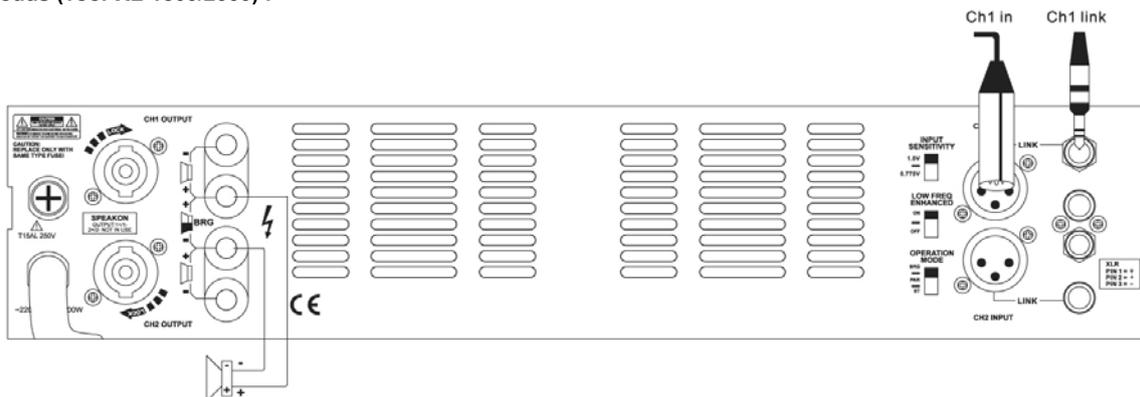
In deze modus wordt alleen ingang CH1 gebruikt. Sluit de audio bron (CD speler, mengpaneel, audio processor enz.) op deze ingang aan. Set de modus schakelaar op BRIDGE. Stel de volumeregelaar van CH1 in en gebruik de twee uitgangsterminal in bridged modus (+terminal van de box op de +terminal van CH1 en -terminal van de box op de +terminal van CH2).
