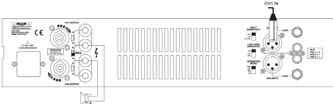
In deze modus wordt alleen ingang CH1 gebruikt. Sluit de audio bron (CD speler, mengpaneel, audio processor enz.) op deze ingang aan. Set de modus schakelaar op BRIDGE. Stel de volumeregelaar van CH1 in en gebruik de twee uitgangsterminal in bridged modus (+terminal van de box op de +terminal van CH1 en -terminal van de box op de +terminal van CH2).
