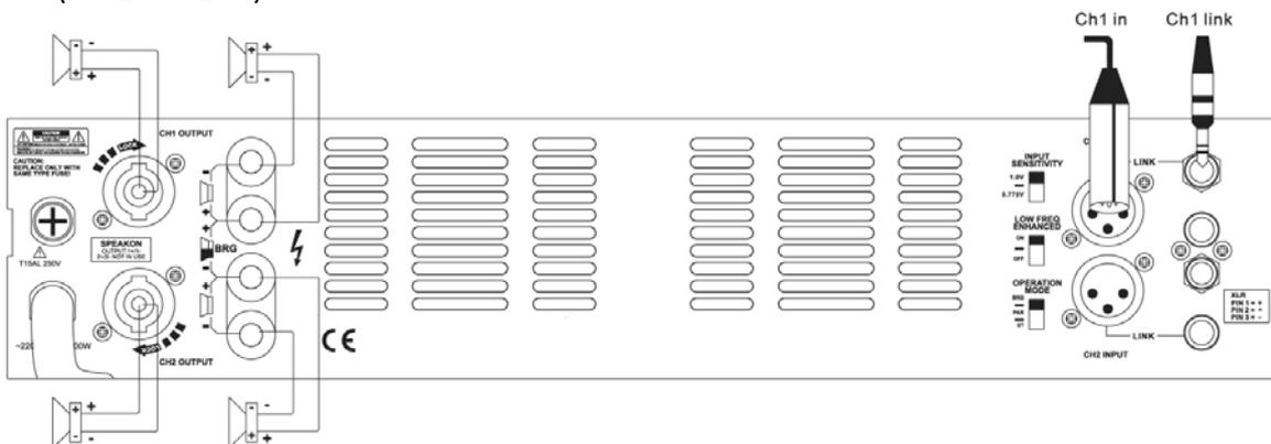
In dieser Betriebsart wird nur der Eingang CH1 benutzt. Schließen Sie die Audioquelle (CD Spieler, Mischpult, Audioprozessor...) an diesen Eingang an. Stellen Sie den Betriebsartwahlschalter auf PARALLEL. Stellen Sie beide Lautstärkereglер separat ein und benutzen Sie die beiden TURNLOCK Ausgänge (oder die beiden Klemmen).
