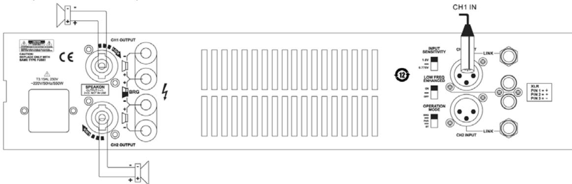
In deze modus wordt alleen ingang CH1 gebruikt. Sluit de audio bron (CD speler, mengpaneel, audio processor enz.) op deze ingang aan. Set de modus schakelaar op PARALLEL. Stel beide volume regelaars gescheiden in en gebruik beide TURNLOCK uitgangen (of de twee terminals).
