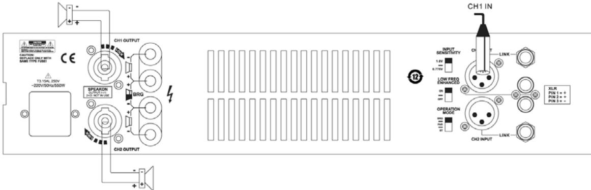
In dieser Betriebsart wird nur der Eingang CH1 benutzt. Schließen Sie die Audioquelle (CD Spieler, Mischpult, Audioprozessor...) an diesen Eingang an. Stellen Sie den Betriebsartwahlschalter auf PARALLEL. Stellen Sie beide Lautstärkeregler separat ein und benutzen Sie die beiden TURNLOCK Ausgänge (oder die beiden Klemmen).
