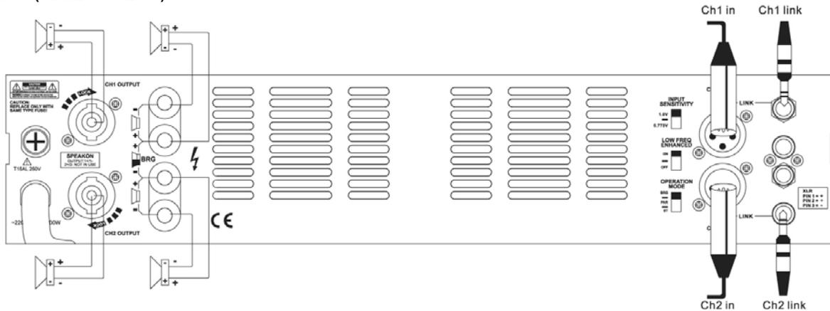
In dieser Betriebsart sind beide Eingänge an die Ausgänge der Audioquelle (CD Spieler, Mischpult, Audioprozessor...) angeschlossen. Stellen Sie den Betriebsartwahlschalter auf STEREO (Werkseinstellung). Stellen Sie beide Lautstärkereglер separat ein und benutzen Sie die beiden TURNLOCK Ausgänge (oder die beiden Klemmen).
