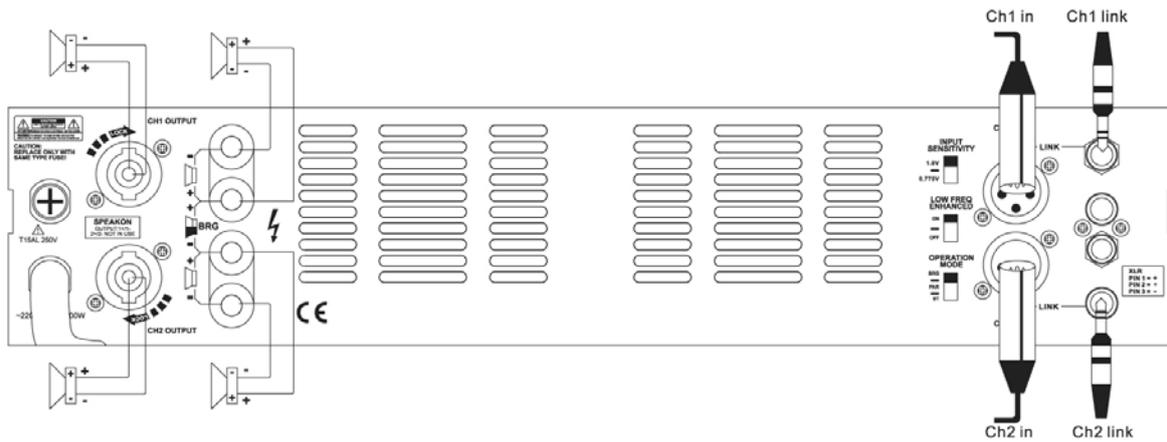
Dans ce mode, les deux entrées sont reliées aux sorties de la source audio ( lecteur CD, table de mixage, processeur audio,... ). Positionnez le sélecteur de mode de fonctionnement sur la position stéréo ( réglage usine ). Ajustez correctement les deux boutons volume séparément et utilisez les deux sorties TURNLOCK ( ou les deux sorties borniers ).
