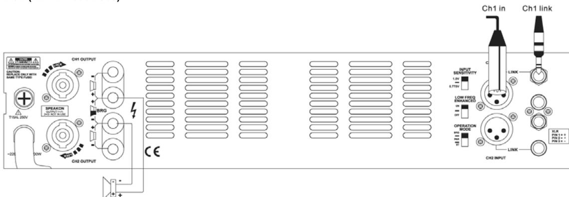
In dieser Betriebsart wird nur der Eingang CH1 benutzt. Schließen Sie die Audioquelle (CD Spieler, Mischpult, Audioprozessor...) an diesen Eingang an. Stellen Sie den Betriebsartwahlschalter auf BRIDGE. Stellen Sie den Lautstärkereglер von CH1 ein und benutzen Sie die beiden Ausgangsklemmen im Brückenbetrieb (+Klemme der Box an +Klemme von CH1 und –Klemme der Box an +Klemme von CH2)
