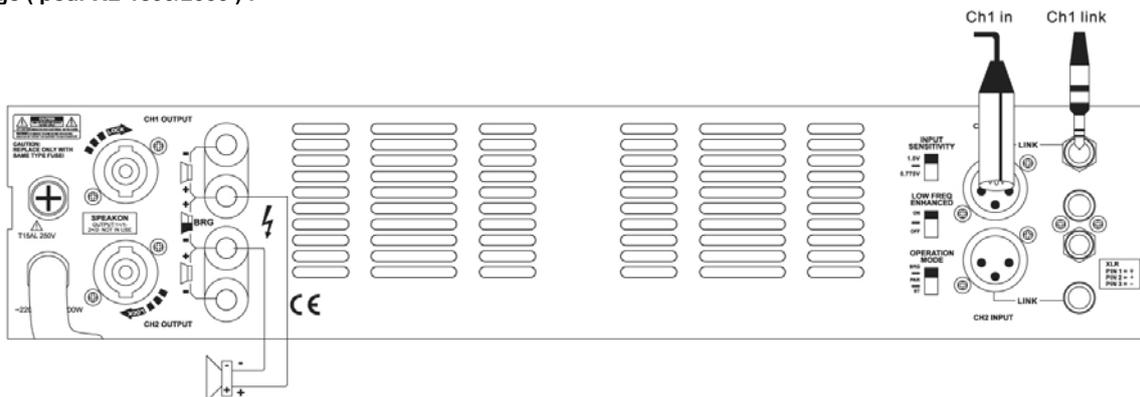
Dans ce mode, uniquement l'entrée CH1 est utilisée. Connectez la source audio ( lecteur CD, table de mixage, processeur audio,... ) sur cette entrée. Positionnez le sélecteur de mode de fonctionnement sur la position bridge. Ajustez correctement le boutons volume CH1 et utilisez les deux sorties borniers en mode bridge ( borne + enceinte sur borne + CH1 et borne – enceinte sur borne + CH2 )
