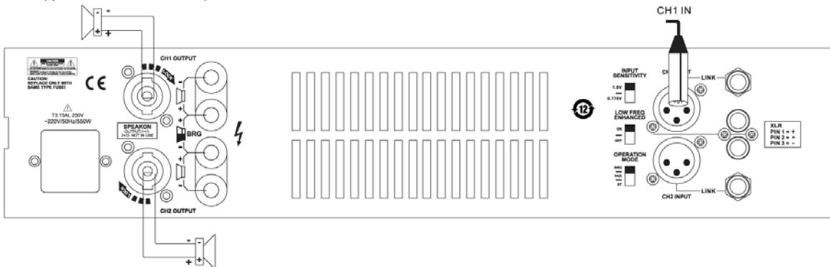
Dans ce mode, uniquement l'entrée CH1 est utilisée. Connectez la source audio ( lecteur CD, table de mixage, processeur audio,... ) sur cette entrée. Positionnez le sélecteur de mode de fonctionnement sur la position parallèle. Ajustez correctement les deux boutons volume séparément et utilisez les deux sorties TURNLOCK ( ou les deux sorties borniers ).
